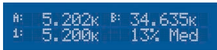
2 つの入力 / 1 つのループを表示した例 2 つの入力と関連する出力を備えた標準的な例。
