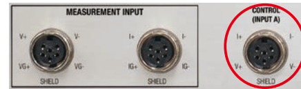
温度コントロール用センサ入力コネクタ
